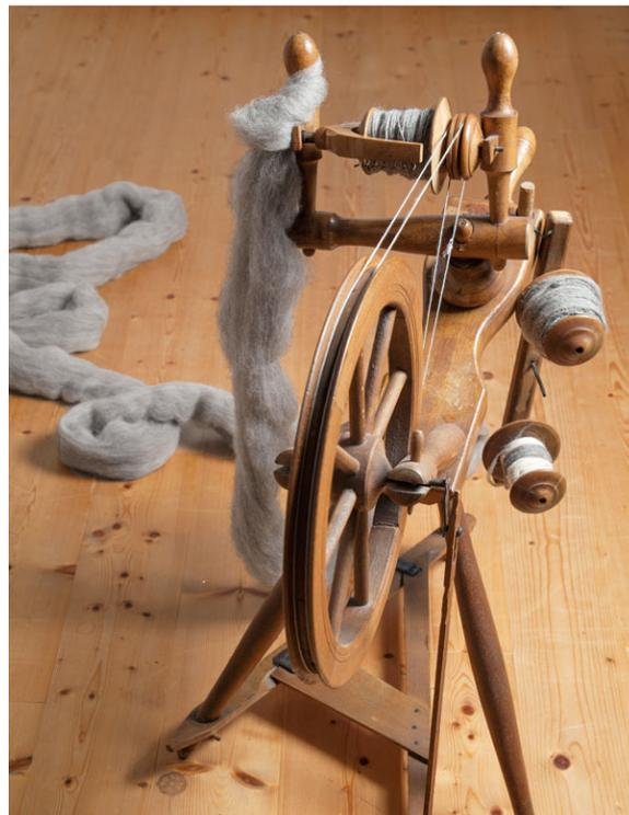
**Spinnen ist die Herstellung von Garn, insbesondere der Garnbildung durch gleichzeitiges Verziehen und Verdrehen. Dadurch wird der Faden fein und fest. Spinnen ist, wie das Weben, eine der ältesten Kulturtechniken der Menschheit. Ursprünglich Handarbeit mit einfachsten Hilfsmitteln. Mit dem Spinnrad ist das Spinnen heute mechanisiert und schneller.**
