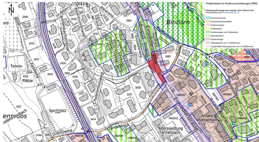
Abbildung 9: Prüferperimeter für Bodenverschiebungen (PBV) (GIS Kanton ZH).
